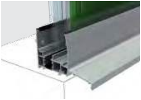
DETALIU PROFIL BAZĂ Profil de bază completat cu barieră termică și picurător
