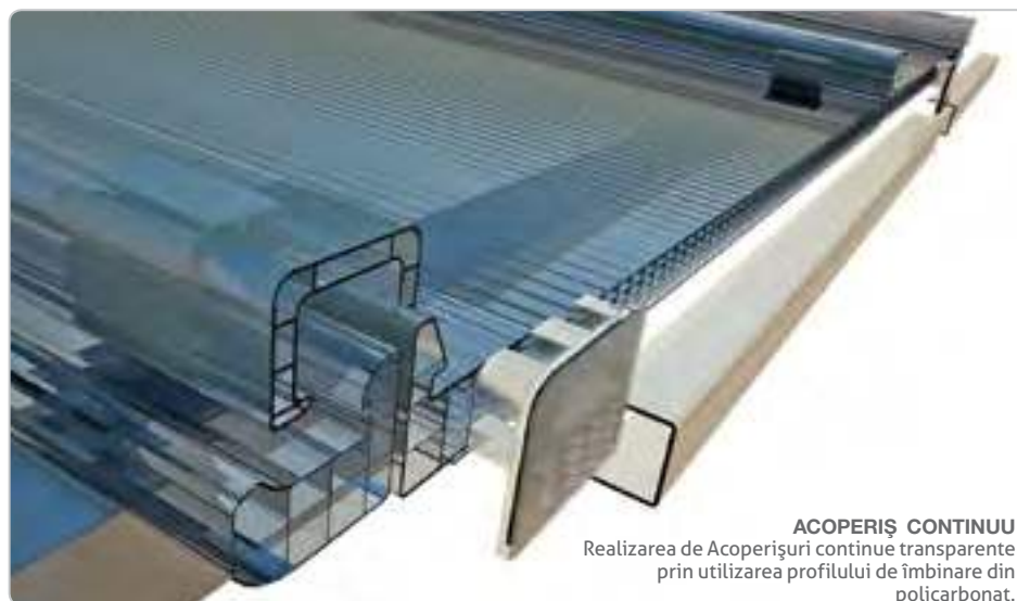
DETALIU START. Profil de start, profil de îmbinare, placă și profile de închidere celule.
