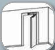
Montaj pe buiandrug pentru 1 canat, sens ușa DIN stânga sau dreapta, braț culisant, acționare prin tragere.
