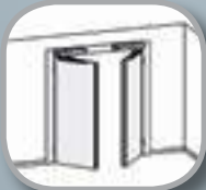
Montaj pe buiandrug pentru 2 canaturi master-slave, 2 canaturi sincronizate cu brațe articulate pentru împingere sau culisante pentru tragere.
