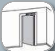
Montaj pe buiandrug pentru 1 canat, sens ușa DIN stânga sau dreapta, braț articulat standard, acționare prin împingere.
